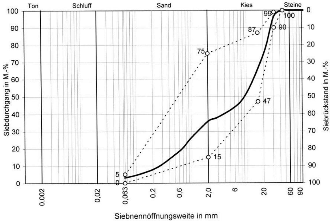
Anmerkung: Die Grenzwerte der Siebdurchgänge bei den Zwischensieben gelten nur für die Verwendung in den oberen 20 cm der FSS.
